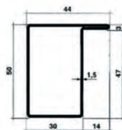
SF 1B - Spessore 1,5 Peso kg/m 2,15
