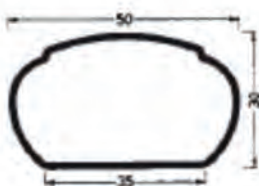
MT 5 - Spessore 15/10 Peso kg/m 1,65
